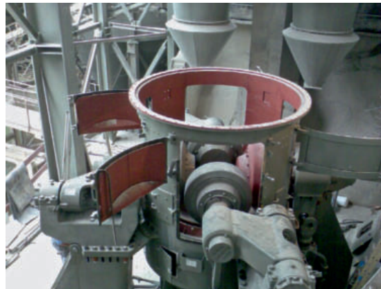
4 Mühlengehäuse der MVR 1800 C-4 mit eingeschwenkten Mahlwalzen
