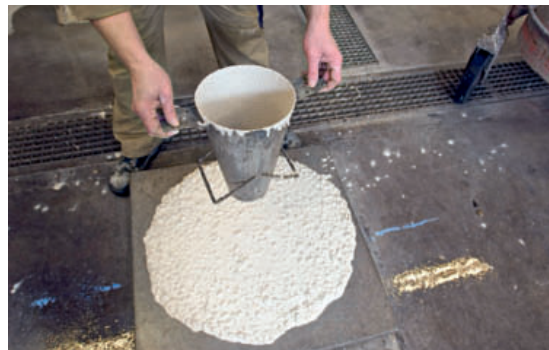
5 Ausbreitmaß-Test zur Qualitätskontrolle
