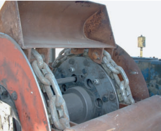
2 Beispiel für ein Rundgliedkettenbecherwerk
