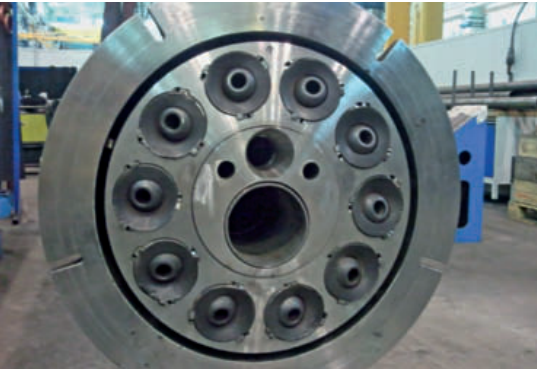
4 Frontalansicht auf einen Sinterzonenbrenner, der für feste und flüssige Brennstoffe ausgelegt wurde (POLFLAME® der ThyssenKrupp Resource Technologie GmbH)
