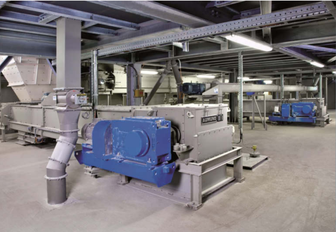
7 Auf Aumund-Standard umgebaute Trogkettenförderer
