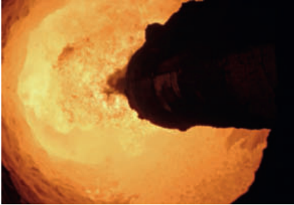
5 Sinterzone und Ofenflamme
