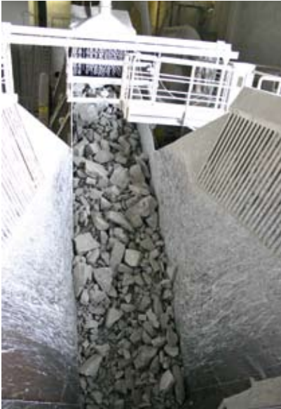
5 500 t/h Mammut crusher of Hirschmann 500 t/h Mammut-Brecher der Fa. Hirschmann
