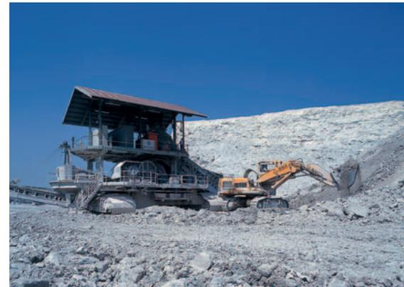
Der im Steinbruch abgebaute Kalkmergel wird in Brechanlagen zunächst zu Schotter zerkleinert
