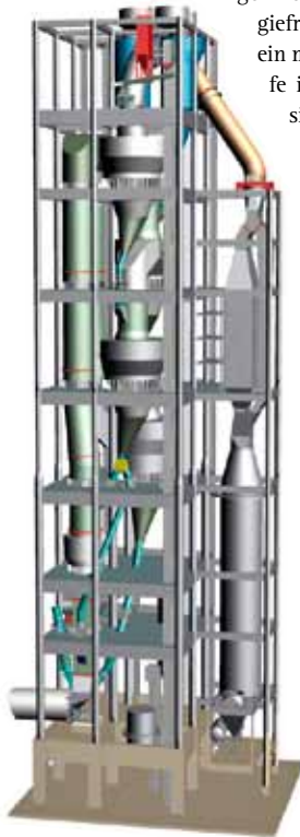
9 KHD-Zyklonwärmetauscher; SCR Reaktor in der Abgasleitung (rechts, oben)
