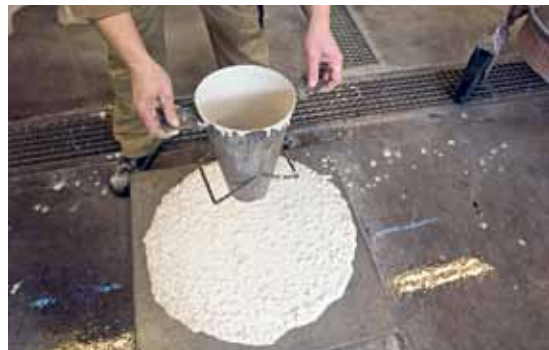
5 Ausbreitmaß-Test zur Qualitätskontrolle
