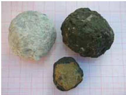
5 Klinker ist das Zwischenprodukt in der Herstellung von Zement. Rechts oben: unter Normalbedingungen gebrannt; links oben: unter reduzierenden Bedingungen gebrannt; mittig unten: reduzierend gebrannter Klinker mit sog. „braunem Kern“
