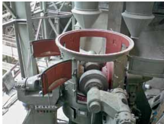
4 Mühlengehäuse der MVR 1800 C-4 mit eingeschwenkten Mahlwalzen
