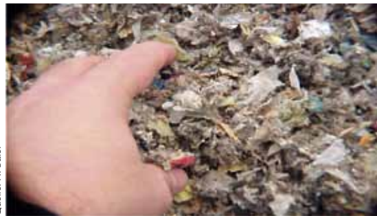
1 Fein aufbereiteter fester Ersatzbrennstoff für den Einsatz im Sinterzonenbrenner
