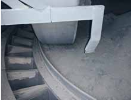
2 Blick auf die Mahlwalze einer MVR
