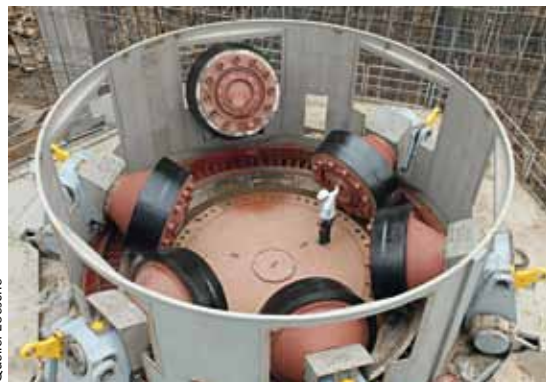
4 Vertikalmühle (Bau) zur Rohmaterialvermahlung
