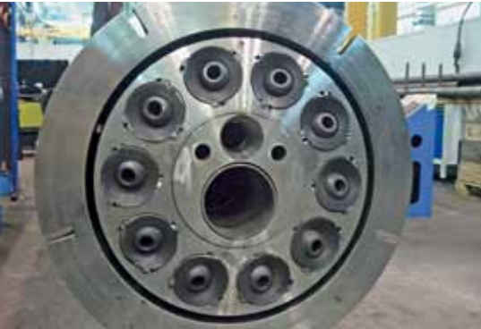
4 Frontalansicht auf einen Sinterzonenbrenner, der für feste und flüssige Brennstoffe ausgelegt wurde (POLFLAME® der ThyssenKrupp Resource Technologie GmbH)
